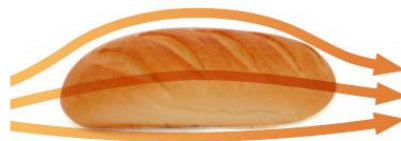
En la figura 2 se pueden observar los flujos de un sistema a doble conducto Wide Flow que permite generar un flujo de aire caliente que envuelve todo el producto.
