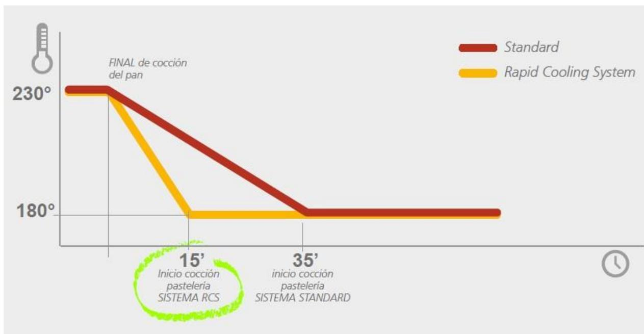
*Rapid Cooling System: desde la cocción del pan hasta la cocción de la pastelería en 15 minutos*
