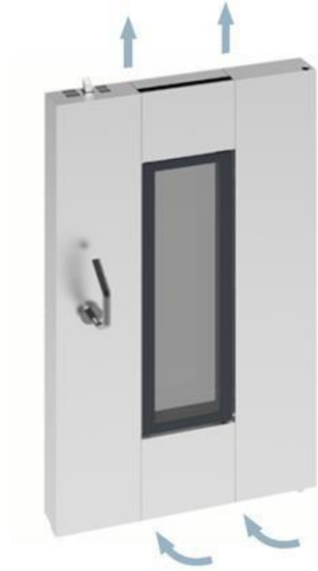
Enfriamiento de la puerta La parte exterior de la puerta se enfría gracias a un sistema específico que hace que fluya el aire a través de un conducto específico.
