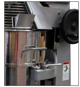
Volante para elevación del cazo
