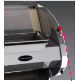
*Paro de emergencia
